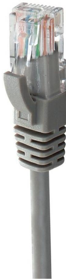
Cavo di rete patch di Cat.6, realizzato con rame 100% per garantire prestazioni elevate. I copriconnettori anti-stress proteggono i connettori RJ45, garantendo una connessione stabile e duratura. Il cavo è testato e conforme alle specifiche Cat.6, con una guaina in LSZH (Low Smoke Zero Halogen), priva di alogeni, che offre maggiore sicurezza in caso di incendio.
